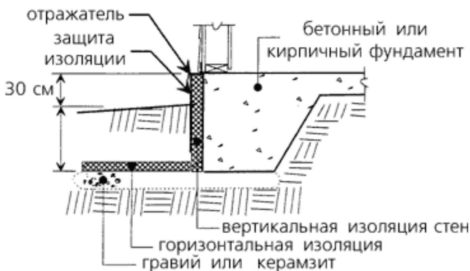
Рис. 5.9. Тепловые потери через пол, цокольные конструкции, стены и пол фундамента.
