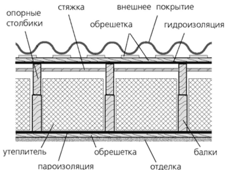
Рис. 5.15. Конструкция утепленной крыши.
